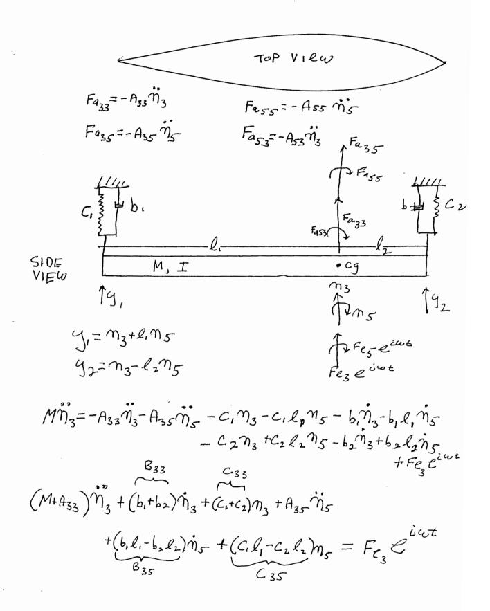
$$I\dot{m}_{s} = -A_{ss}\dot{m}_{s} - A_{ss}\dot{m}_{s} - c_{s}l_{1}m_{s} - c_{s}l_{1}m_{s} - b_{s}l_{1}m_{s} - b_{s}l_{1}m_{s} - b_{s}l_{1}m_{s} + c_{2}l_{2}m_{s} - c_{s}l_{2}m_{s} - b_{2}l_{2}m_{s} - b_{2}l_{2}m_{s} + F_{e_{s}}e^{i\omega t}$$
