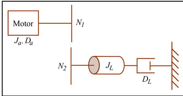
$$\begin{aligned} N_1 : N_2 &= 25 : 250 \\ J_a &= 0.02 \text{ kg} \cdot \text{m}^2 \\ J_L &= 1 \text{ kg} \cdot \text{m}^2 \\ D_a &= 0.01 \text{ kg} \cdot \text{m}^2 / \text{sec} \\ D_L &= 1 \text{ kg} \cdot \text{m}^2 / \text{sec} \end{aligned}$$
