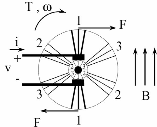
$$\begin{bmatrix} v_e \\ i \end{bmatrix} = \begin{bmatrix} 2BNlr & 0 \\ 0 & \frac{1}{2BNlr} \end{bmatrix} \begin{bmatrix} \omega \\ T \end{bmatrix}$$
