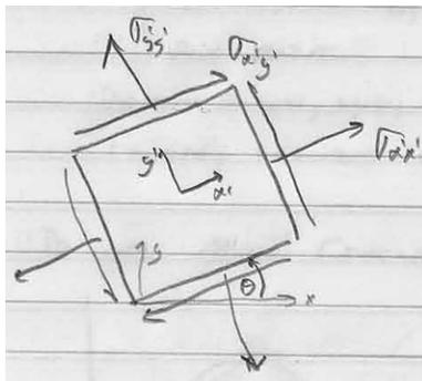
$$[\sigma] = \begin{vmatrix} \sigma'_{x'x'} & \sigma'_{x'y'} \\ \sigma'_{x'y'} & \sigma'_{y'y'} \end{vmatrix}.$$
