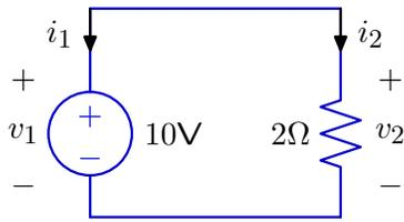
*Example 7.* Find  $v_1$ ,  $v_2$ ,  $i_1$ , and  $i_2$ .
