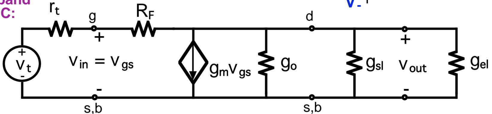
**We find:**  $A_v = v_{out} / v_{in} \approx -g_m R_F$
