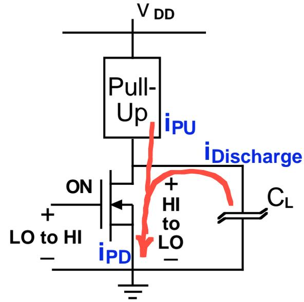
**Discharging cycle:**  $i_{\text{Discharge}} = i_{\text{PD}} - i_{\text{PU}}$
