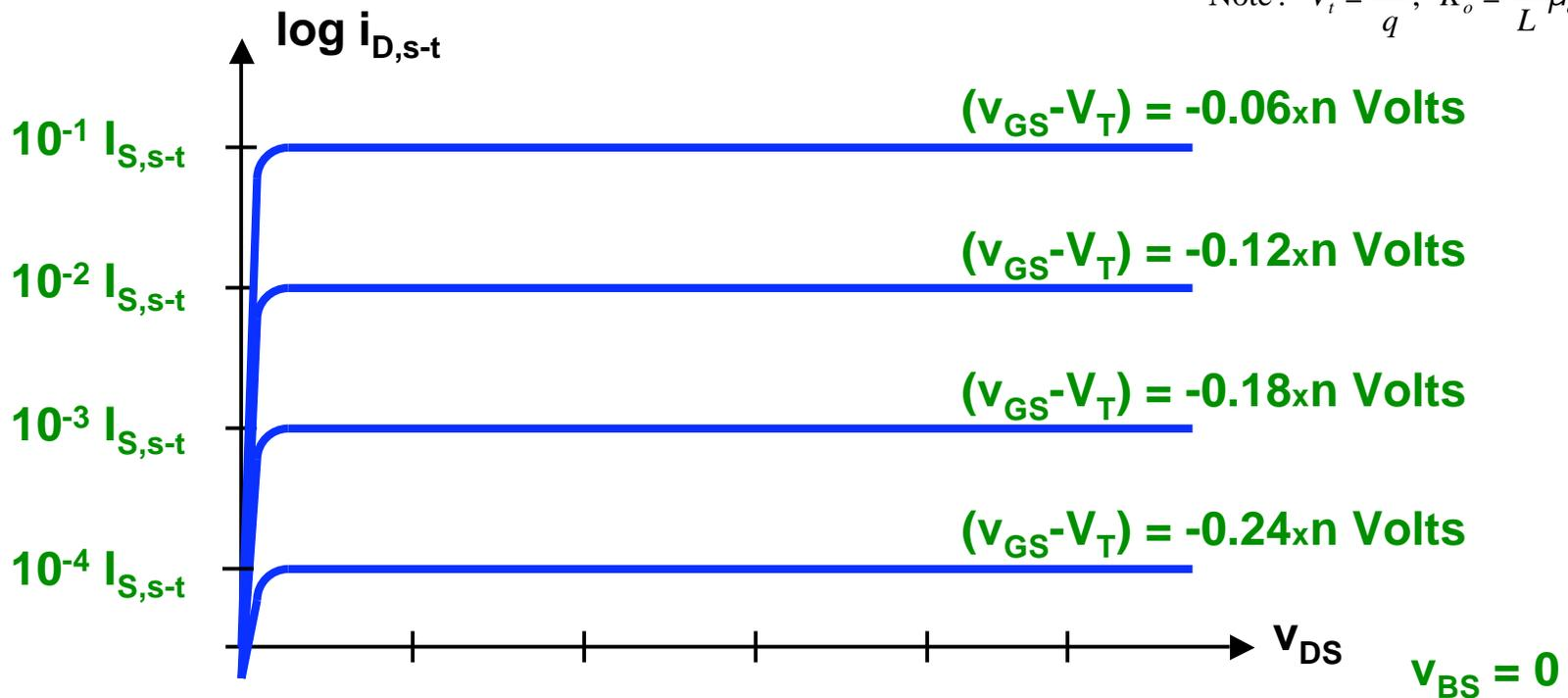
$$i_{D,s-t}(v_{GS}, v_{DS}) \approx I_{S,s-t} e^{q\{v_{GS} - V_T\}/n kT} (1 - e^{-qv_{DS}/kT})$$
