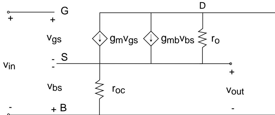
$$\downarrow \quad v_{bs} = -v_{out}$$
