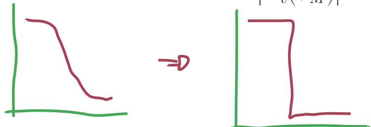
$$NM_L \rightarrow V_M - V_{MIN} \quad NM_H \rightarrow V_{MAX} - V_M$$
