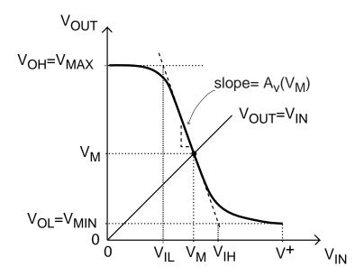
$$|A_{v}(V_{M})| \simeq \frac{V_{MAX} - V_{M}}{V_{M} - V_{IL}} \Rightarrow V_{IL} \simeq V_{M} - \frac{V_{MAX} - V_{M}}{|A_{v}(V_{M})|}$$
