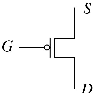
on when  $v_{GS} \leq V_{TP}$
