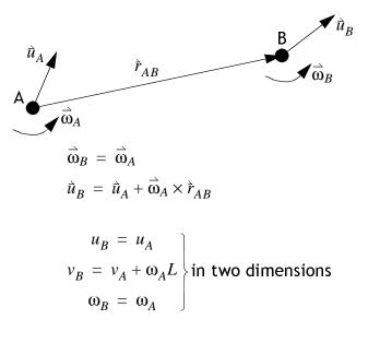
$$\begin{bmatrix} u_B \\ v_B \\ \omega_B \end{bmatrix} = \begin{bmatrix} 1 & 0 & 0 \\ 0 & 1 & L \\ 0 & 0 & 1 \end{bmatrix} \begin{bmatrix} u_A \\ v_A \\ \omega_A \end{bmatrix}$$
