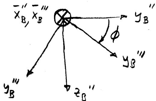
$$T_1(\phi) = \begin{bmatrix} 1 & 0 & 0 \\ 0 & c\phi & s\phi \\ 0 & -s\phi & c\phi \end{bmatrix}$$
