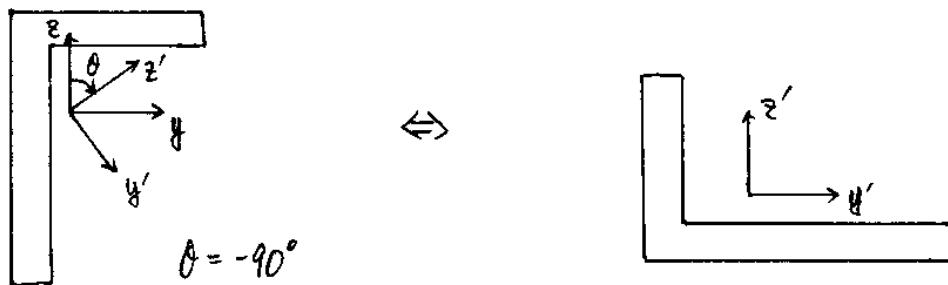
$$\begin{Bmatrix} I_{y'} \\ I_{z'} \\ I_{yz'} \end{Bmatrix} = \begin{bmatrix} \cos^2(-90) & \sin^2(-90) & \cos(-90)\sin(-90) \\ \sin^2(-90) & \cos^2(-90) & -\cos(-90)\sin(-90) \\ -2\cos(-90)\sin(-90) & 2\cos(-90)\sin(-90) & \cos^2(-90) - \sin^2(-90) \end{bmatrix} \begin{Bmatrix} I_y \\ I_z \\ I_{yz} \end{Bmatrix}$$
